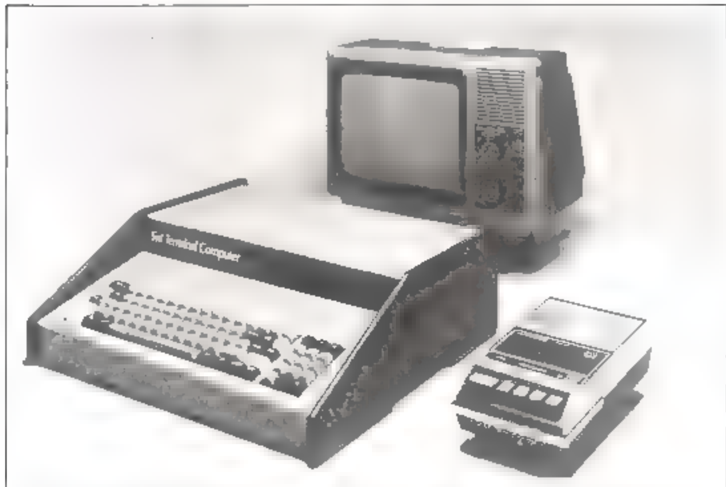
Photo 1 - Un système individuel type comme celui représenté ci-dessus comprend: un boîtier qui héberge le micro-ordinateur et le clavier, un poste de télévision domestique et un simple magnétophone à cassette pour le stockage des programmes (D.S. Syber).
